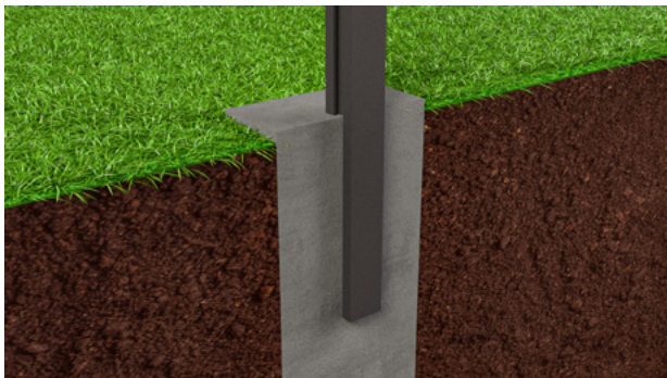
Pfosten einbetonieren mit Nutenstein
