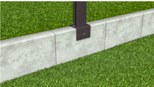
Montage mit L-Stein Fußplatte auf Mauer
